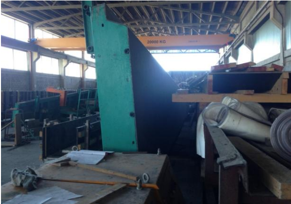
12./13. Mosna dizalica T-1172 (granik s dva glavna nosača), nosivost Q/g = 20 000 kg,
