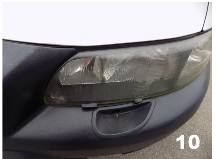
10. Volvo – oštećenje fara
