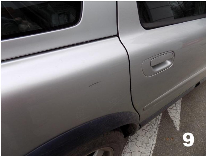
9. Volvo – oštećenje desne stijene
