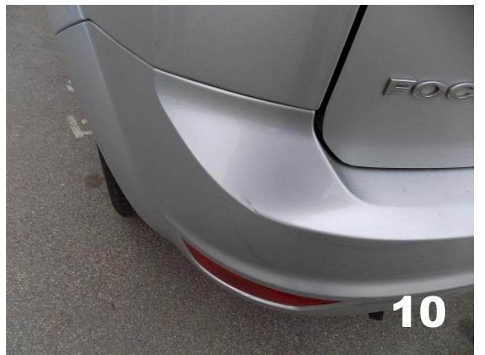
10. Ford – oštećenje zadnjeg branika
