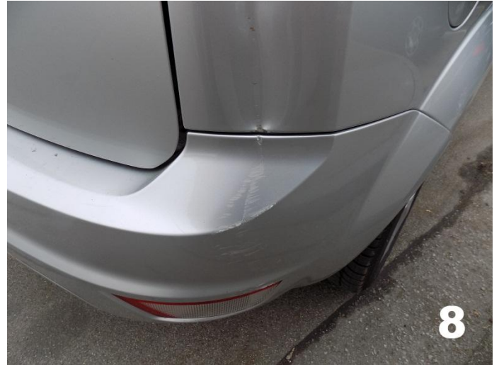
8. Ford – Oštećenje zadnjeg branika
